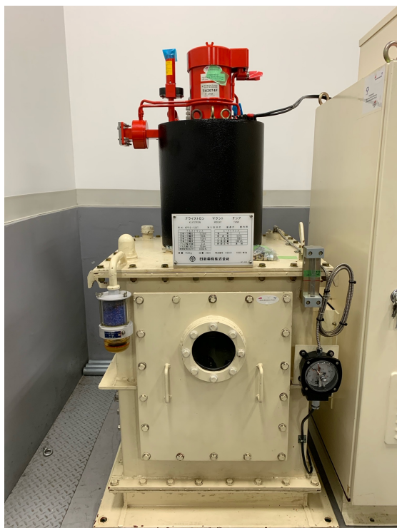
小型大電力高周波増幅器と駆動パルス電源
