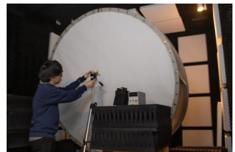
電波暗室内にある直径1.8mパラボラアンテナと76GHzミリ波発振器
